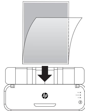
→ Laite vetää laminointikalvon sisään, ja kalvo tulee ulos laminointilaitteen ulostulupoelta (etupuolelta).
