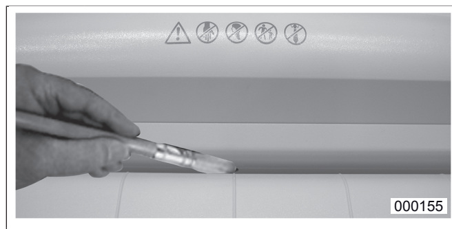
fig.7 Nettoyage des cellules photoélectriques
