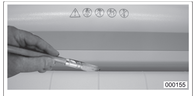
Fig. 7 Limpieza de las fotocélulas
