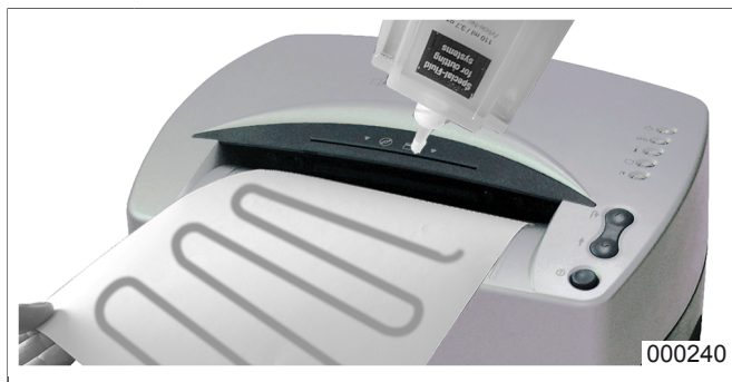
fig. 5 Lubrifier le bloc de coupe
