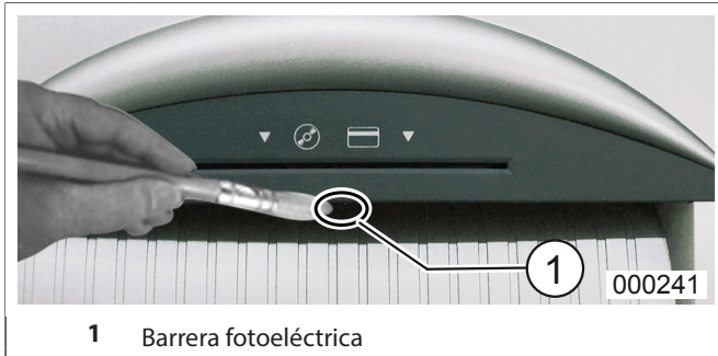
fig. 4 Limpieza de las fotocélulas
