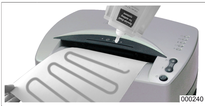
fig. 5 Engrasado del mecanismo de corte
